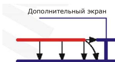
Рис.4-2 Дальнейшее улучшение для уменьшения излучения силовой плоскости
