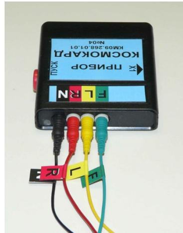
Подключение кабеля отведений к прибору
