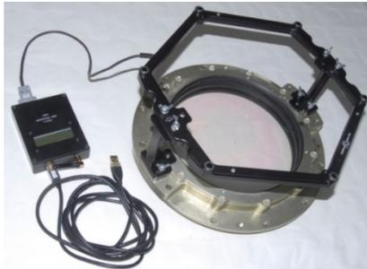
Устройство управления и платформа приемников на иллюминаторе
