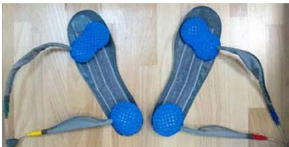
Стельки с установленными пневмокамерами
