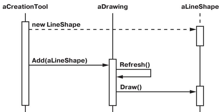
Рис. Б.3. Нотация схем взаимодействий
