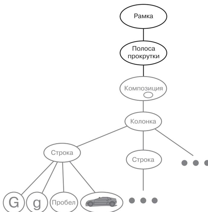
**Рис. 2.8.** Объектная структура после добавления элементов оформления
