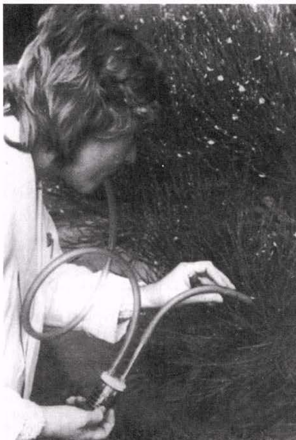
Рис. 11.11. Аспиратор для сбора мелких беспозвоночных.
