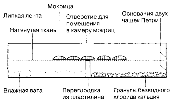
Рис. 17.57. Прибор для изучения ориентации у мокриц.
