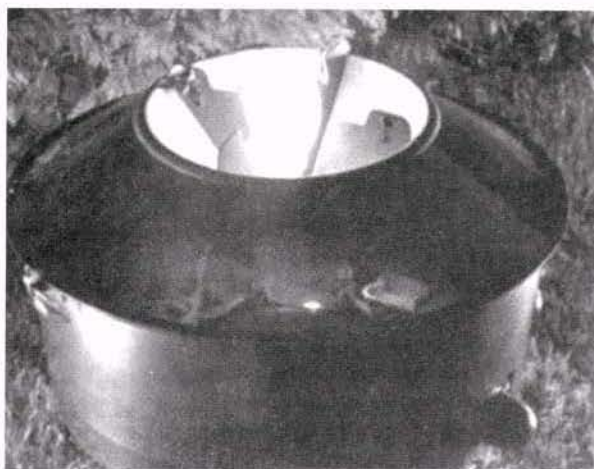
Рис. 11.6. Световая ловушка с ртутной лампой для ловли насекомых.
