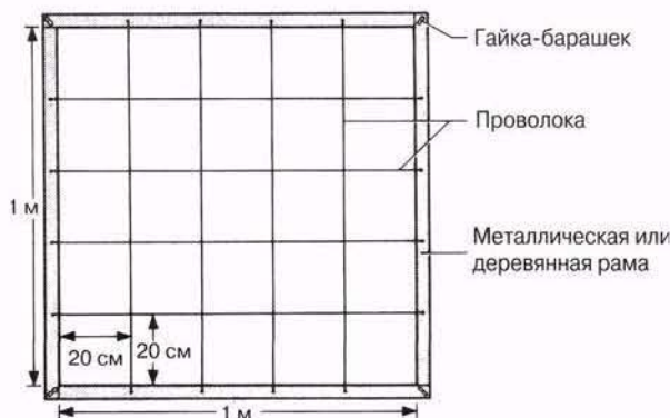
Рис. 11.12. Квадратная рама (1 м 2 ), разделенная проволочной сеткой на меньшие квадраты, каждый площадью по 400 см 2 (градуированный квадрат).
