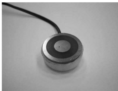
Рис. 4.25. Концентрические электроды: слева — ЭРПК (ООО Элимед , Львов, Украина), справа — из комплекта поставки реографа РПКА2-01 (НТЦ Медасс , Москва)
