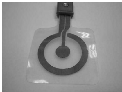
Рис. 4.25. Концентрические электроды: слева — ЭРПК (ООО Элимед , Львов, Украина), справа — из комплекта поставки реографа РПКА2-01 (НТЦ Медасс , Москва)
