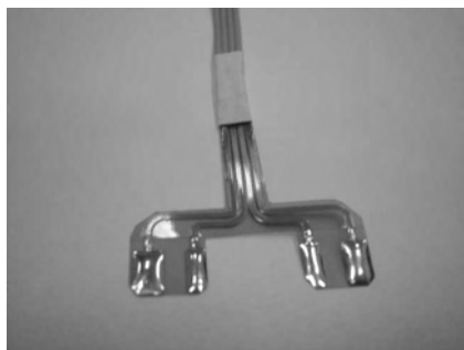
Рис. 4.24. Четырехэлектродная система для исследований участка десны (НТЦ Медасс , Москва)
