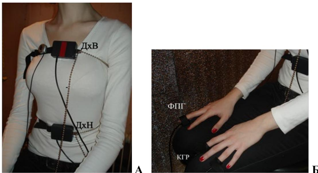
Рисунок 1. Датчики верхнего (ДхВ) и нижнего (ДхН) дыхания; кожно-гальванического рефлекса (КГР), фотоплетизмограммы (ФПГ).
