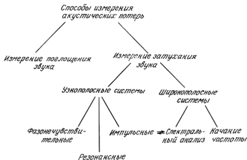
Рис. 4.4. Классификация способов измерения акустических потерь (пояснения в тексте). Данная классификация носит отчасти искусственный характер, поскольку многие методы взаимосвязаны друг с другом.
