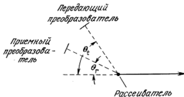
Рис. 11.1. Конфигурация, в которой при движении рассеивателя относительно неподвижных излучателя (передаточного преобразователя) и наблюдателя (приемного преобразователя) возникает доплеровский сдвиг частоты.
