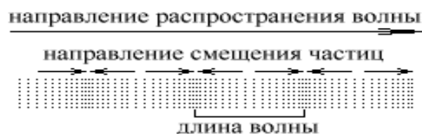
Рис. 1. Распространение продольной волны
