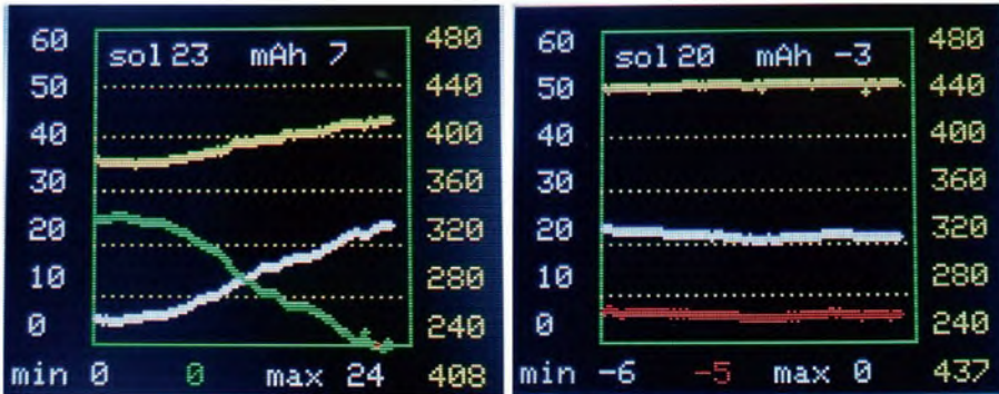
Рисунок 18-17. Работа солнечной панели с отображением тока и напряжения аккумуляторной батареи
