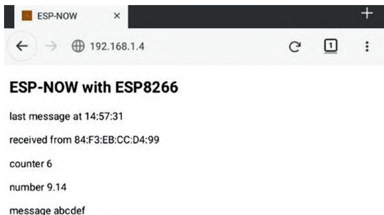
Рисунок 14-2. Прием на микроконтроллер ESP8266 с помощью ESP-NOW и WebSocket
