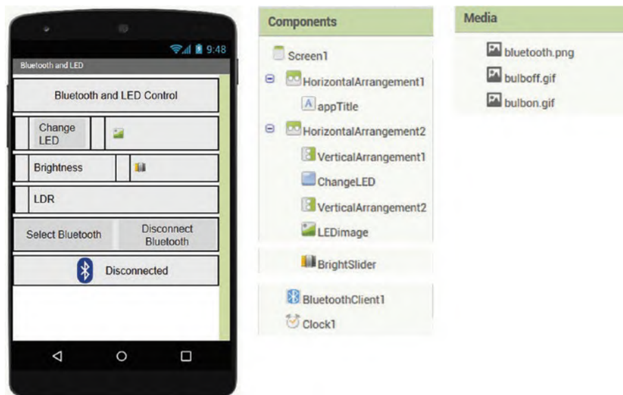
Рисунок 10-4. Макет приложения для Bluetooth-управления светодиодом
