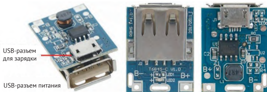
Рисунок 6-4. USB-модуль для зарядки литий-ионного аккумулятора со встроенным повышающим преобразователем T6845
