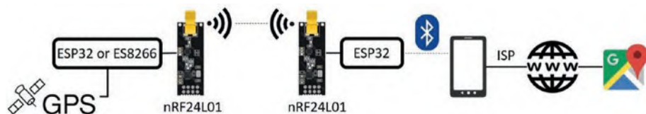
Рисунок 12-1. Приложение для GPS-трекинга с модулями приемопередатчиков nRF24L01
