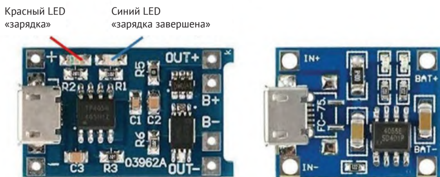
Рисунок 6-2. Модули TP4056 для зарядки Li-ion-аккумуляторов
