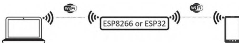
Рисунок 7-1. Беспроводная локальная сеть с микроконтроллером ESP8266 или ESP32
