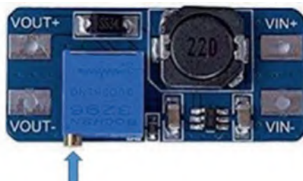
Рисунок 6-1. Повышающий преобразователь постоянного тока MT3608
