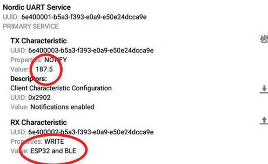
Рисунок 22-6. Передача и прием с помощью BLE
