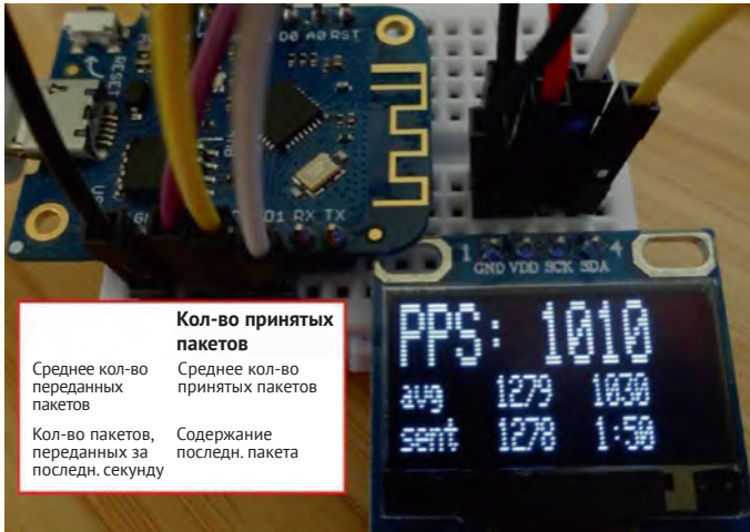
Рисунок 12-14. Пакеты nRF24L01 (принятые/переданные) в секунду
