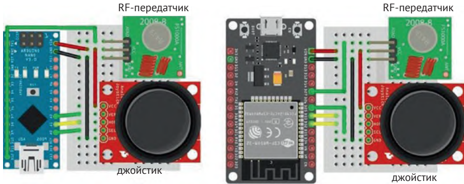
Рисунок 15-7. Передача сигналов джойстика
