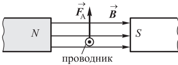
Рис. 19.12. Сила, действующая на проводник с током в магнитном поле
