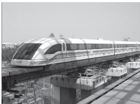
Рис. 43.7. Поезд на магнитной подушке (маглев), связывающий г. Шанхай (Китай) с аэропортом. Дорога протяженностью 30 км была открыта в 2002 г., поезд развивает скорость до 450 км/ч (фото из Википедии)
