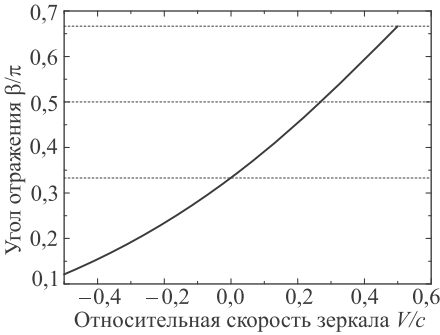
Рис. 32.4. Зависимость угла отражения от скорости зеркала. Пунктирные горизонтальные линии отмечают характерные значения: \beta = \alpha при V = 0 , \beta = \pi/2 при V = c(1 - \sin \alpha)/\cos \alpha и \beta = \pi - \alpha при V = c \cos \alpha
