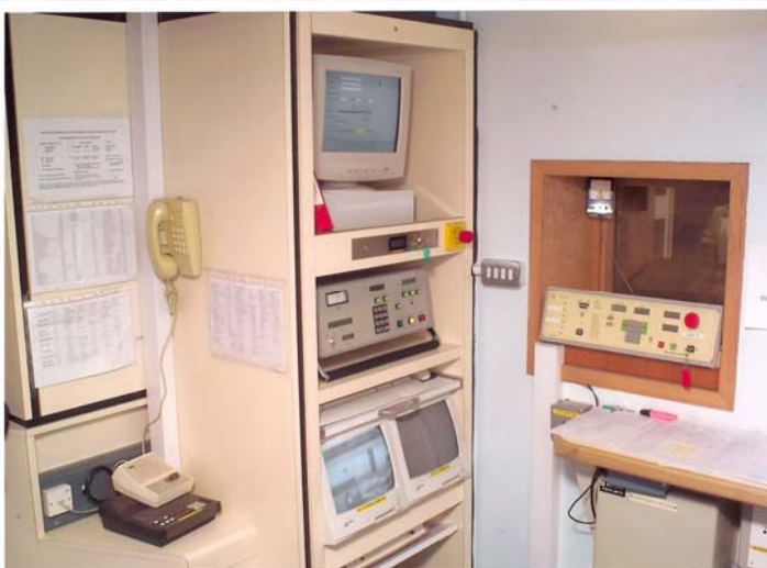
Рис. 120. Специализированный терапевтический комплекс на основе малогабаритного бетатрона с выведенным пучком на энергию 10 МэВ, предназначенный для лечения грибовидной (фунгроидной) гранулемы и других поверхностных заболеваний: а) общий вид спец. комплекса; б) расположение пациента во время процедуры; в) пульт управления специализированным комплексом
