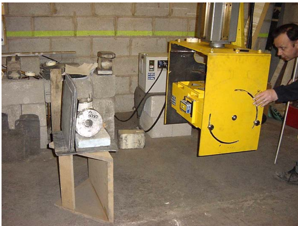
Рис. 85. Малогабаритный бетатрон на промышленном предприятии в Великобритании. Контроль литых деталей с эквивалентной толщиной стали 300 мм
