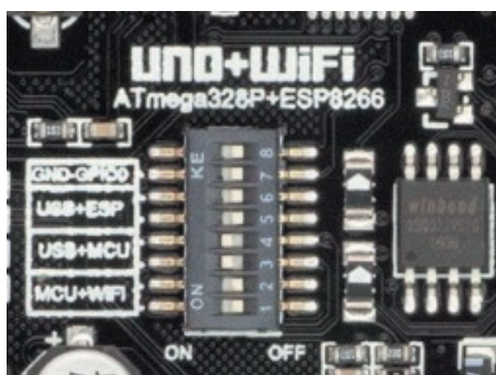
Рис. 012. Переключатели на плате Arduino+WiFi от компании RobotDyn
