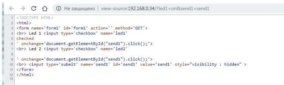
Рис. 68.5. Код страницы управления светодиодами
