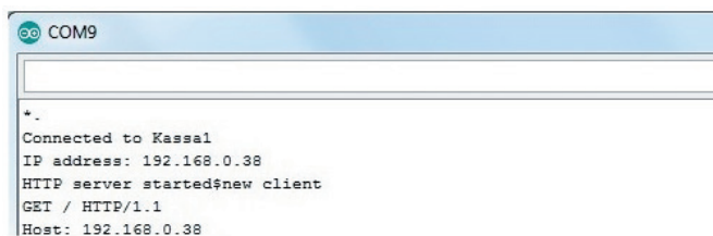
Рис. 77.1. Получение модуля ESP8266 к WiFi-сети
