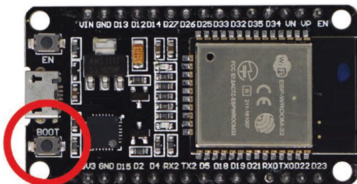
Рис. 1-10. Кнопка BOOT на ESP32
