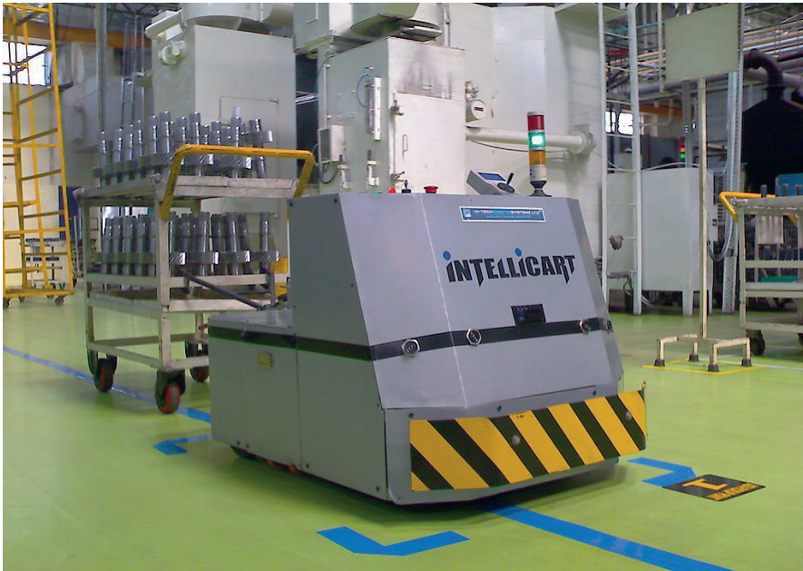
Рис. 14.1. IntelliCart – промышленный робот, отслеживающий линии, от компании Mukeshhrs (фото в открытом доступе)
