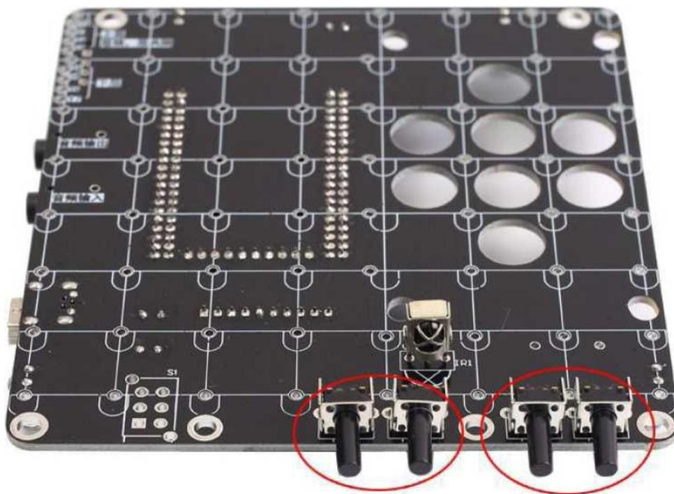
Шаг 11: Установите 1 красный самоблокирующийся выключатель питания на S1 с той же стороны VS1838B.
