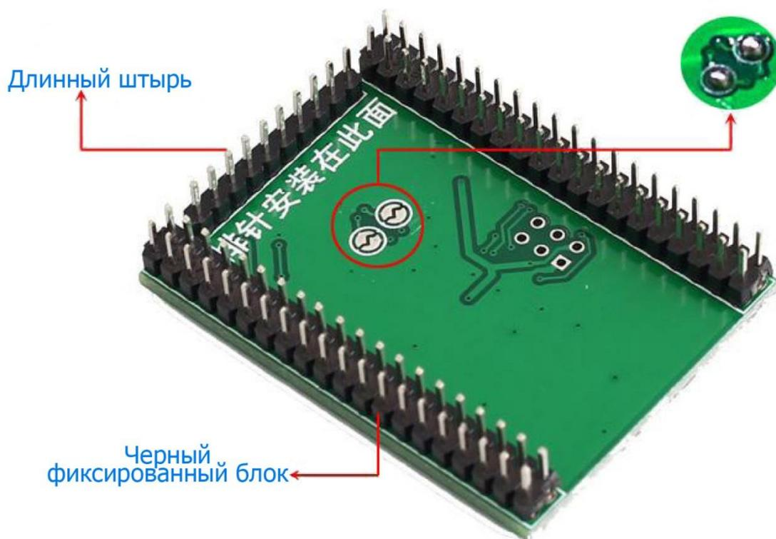
Шаг 2: Установите 2 шт. 20-контактного разъема\*2 1,27 мм и 1 шт. 10-контактного разъема.
