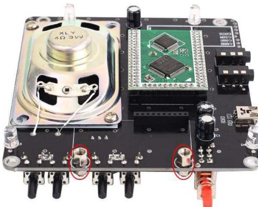
Шаг 14: Установите 1 модуль усилителя Bluetooth и закрепите его винтом.
