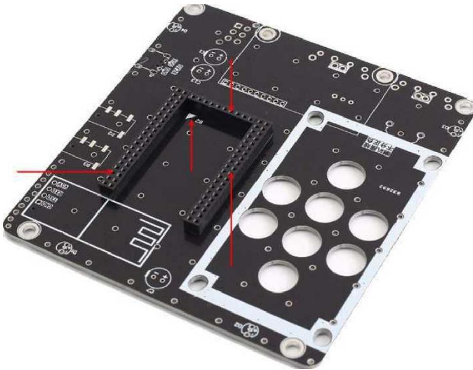
Шаг 3: Установите 1 зеленый модуль основного контроллера ИС на гнездовой разъем, который был установлен на шаге 2.
