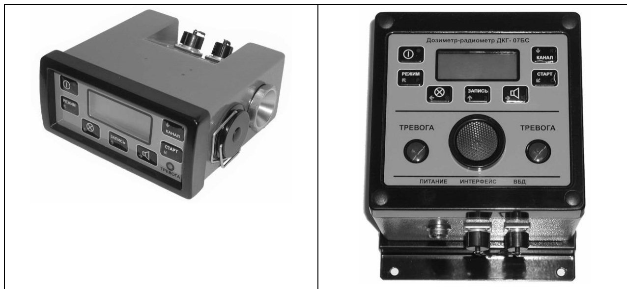
Рис. 1.4.1. Внешний вид пульта дозиметра (МКС-07Н– слева, ДКГ-07БС – справа).
