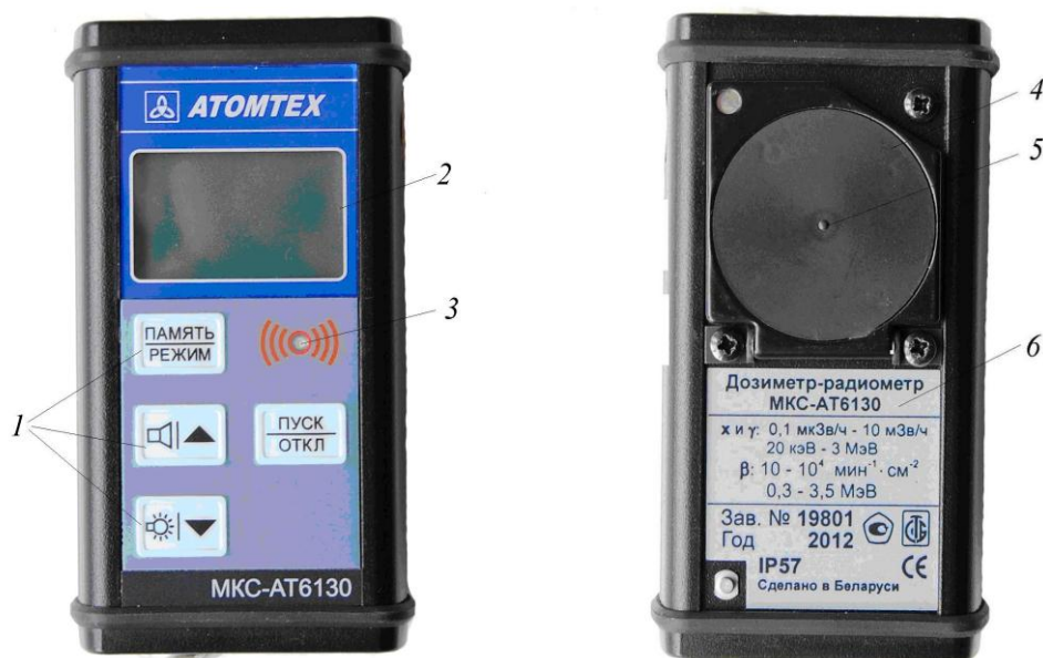
Рис. 1. Общий вид дозиметра-радиометра MKS-AT6130:
