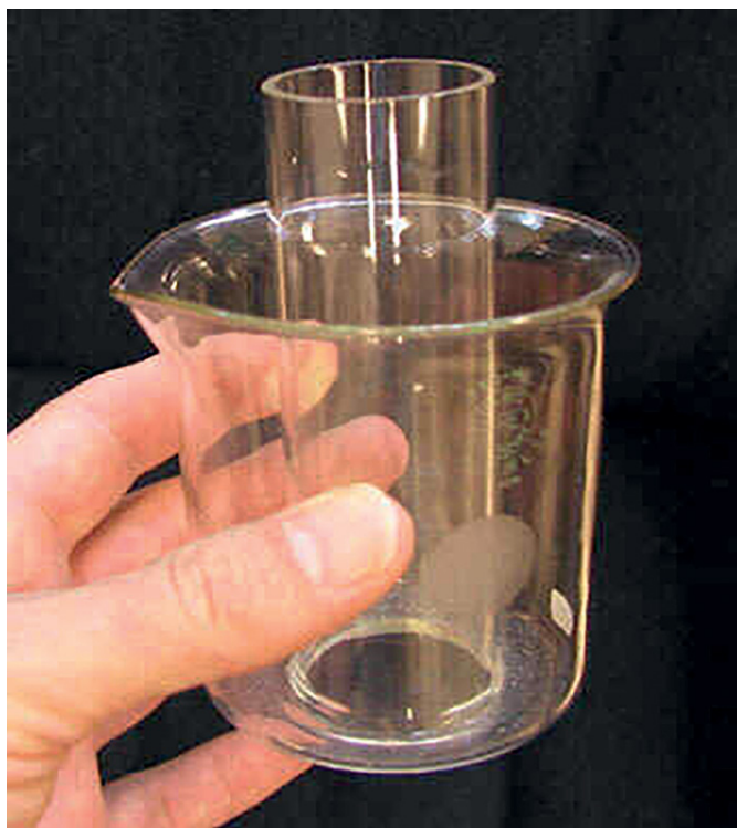
Рисунок 2. Сосуд Маринелли (оригинальная версия).
