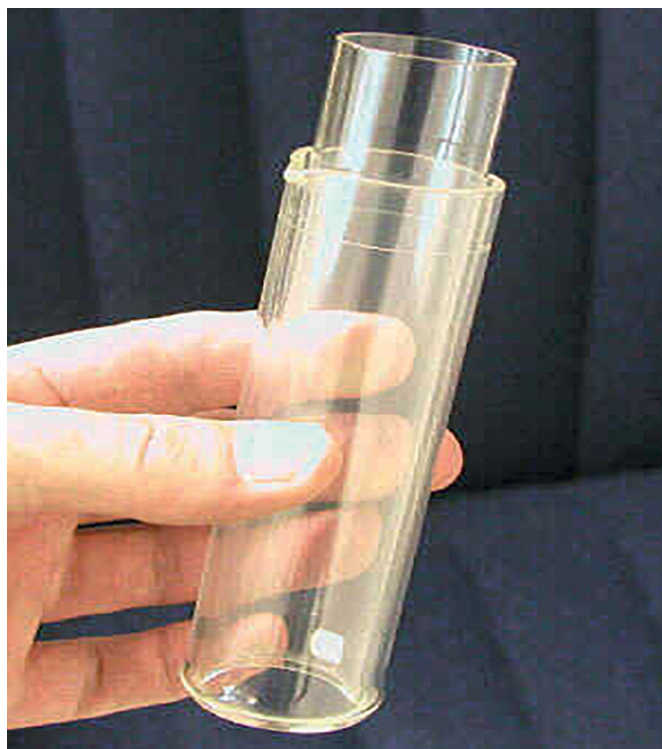
Рисунок 3. Сосуды Маринелли (лабораторный вариант).
