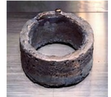
Кольцо чистого, электрорафинированного оружейного плутония (99,9 %).
