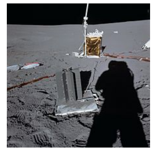
РИТЭГ SNAP-27, применявшийся в миссии Аполлон-14 (в центре).
