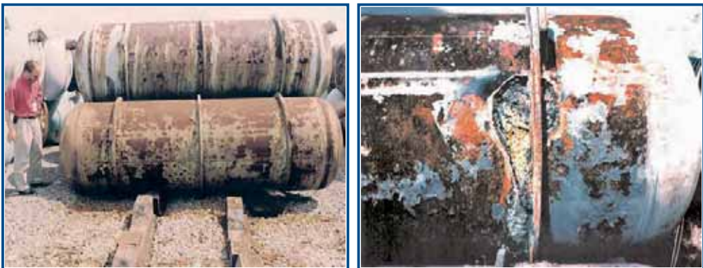
Рис. 1.123. Баллоны с гексафторидом урана на полигонах DOE (слева) и баллон, потерявший герметичность вследствие процессов коррозии (справа)
