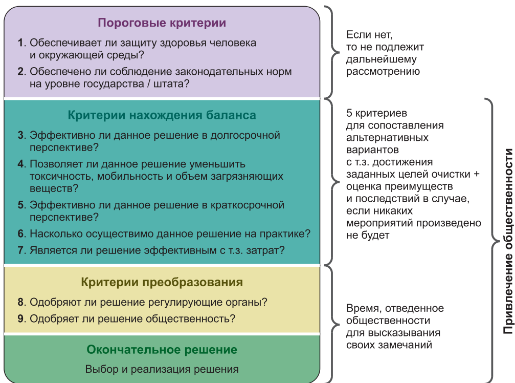
Рис. 1.77-2. Схема сравнения различных вариантов реализации мероприятий по очистке загрязненных территорий на основании девяти критериев EPA
