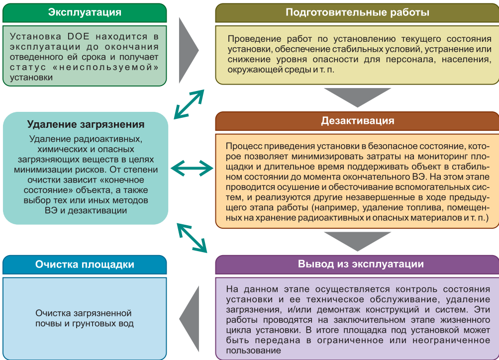
Рис. 1.104. Основные этапы, предшествующие приведению установки в «конечное состояние»
