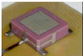
Рис. 88: Керамическая планарная inverted-f-antenna (PIFA) и PIFA для сотового телефона
