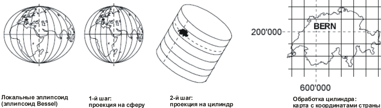
Рис.59 Принцип двойного проецирования
