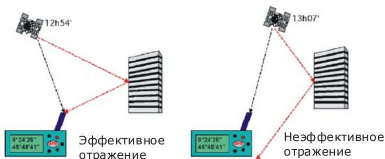
Рис. 61: Влияние времени измерения на отражения
