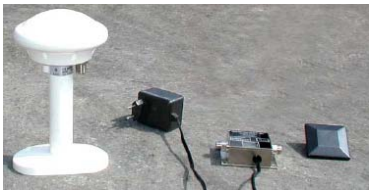
Рис. 75: GNSS усилитель (внешняя антенна, электрический адаптер и силовой провод, усилитель и внутренняя антенна)
