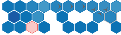
Рис. 9.7. Одниочная итерация эвристического поиска с разметкой выполняет исследовательский прогон (стрелки), за которым следует разметка (шестиугольная рамка). В этой итерации помечены только два состояния: скрытое конечное состояние и состояние с шестиугольной рамкой. И исследовательский прогон, и шаг разметки обновляют функцию полезности
