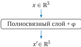
Рис. D.1. Полносвязный слой с трехкомпонентным входом и пятикомпонентным выходом
