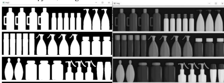
Рис. 17. Изображение на входе программы и изображение после бинаризации
