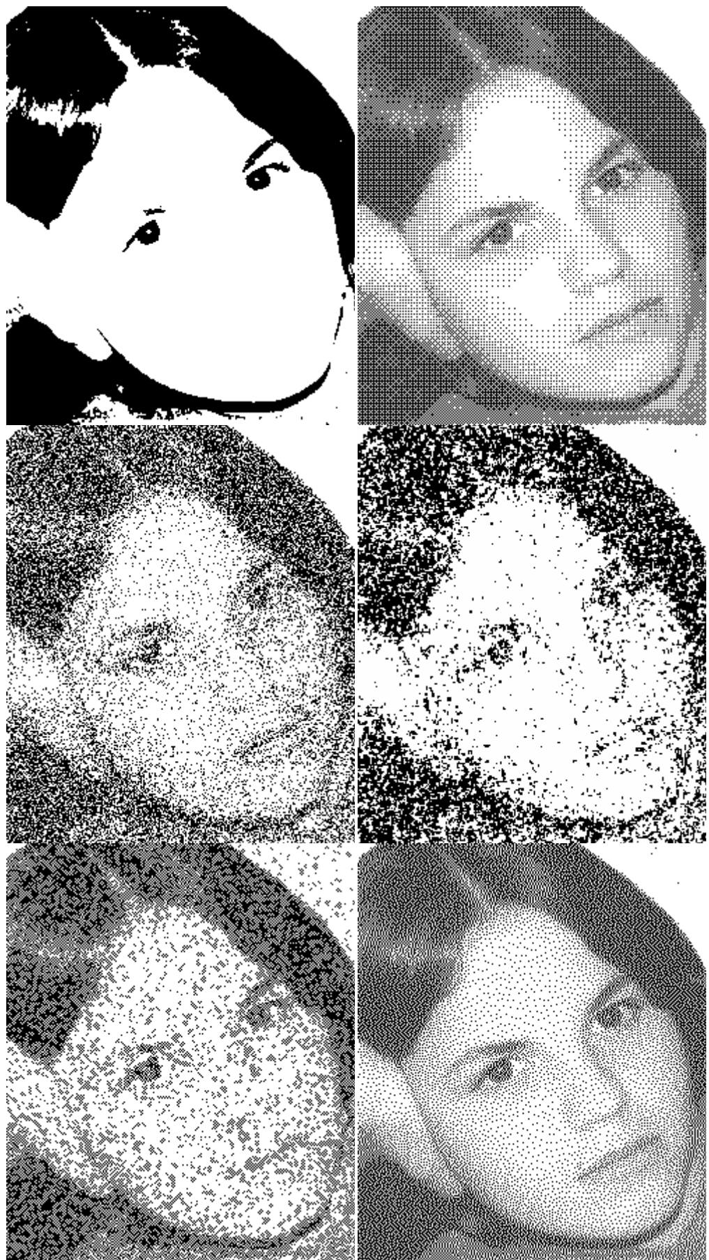
Рис. 15. Различные методы пресвдотонирования изображений (слева направо, сверху вниз): порог, упорядоченное пресвдотонирование, диттеринг белым шумом, диттеринг светло-розовым шумом, диттеринг голубым шумом, диттеринг с диффузией ошибки.
