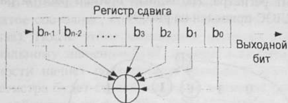
Рис. 88. Регистр сдвига с линейной обратной связью (РСЛОС)
