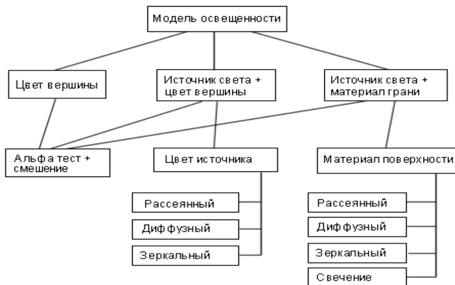
Рис. 244 Схема моделей освещенности в OpenGL.
