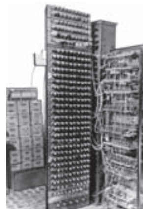
АЦВМ М-1. Вид с лицевой стороны АУ
