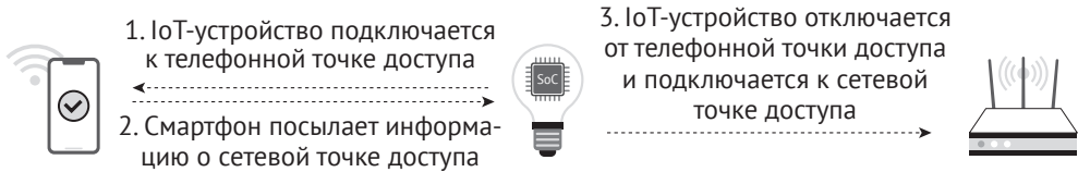
Рисунок 7.30. Этапы настройки сетевой телефонной точки доступа
