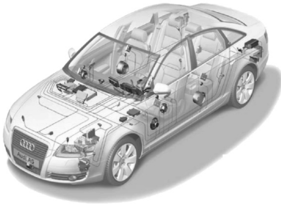
Рис. 38. Пример схематичного размещения устройств, подключенных к CAN-шине автомобиля
