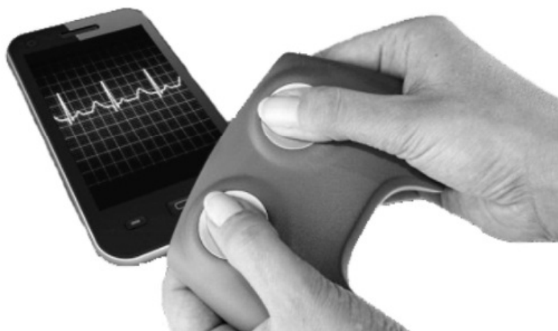
Рис. 29. Датчик бесконтактного измерения электрических потенциалов
