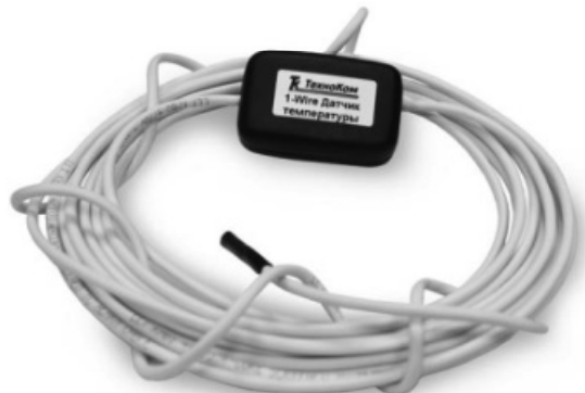
Рис. 34. Датчик температуры воздуха в рефрижераторе
