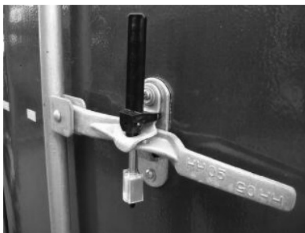
Рис. 40. Установка электронной пломбы IP-UHF-BiT Intermodal Seal на контейнере
