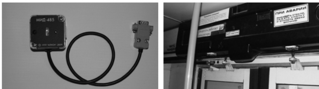
Рис. 33. Инфракрасный датчик контроля пассажиропотока МИД-485
