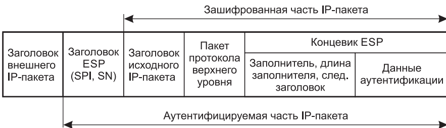
Рис. 29.18. Структура IP-пакета, обработанного протоколом ESP в туннельном режиме
