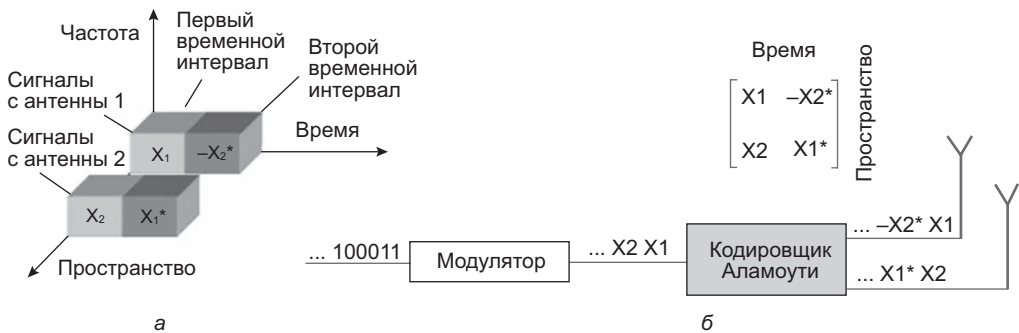
Рис. 21.12. Алгоритм Аламути: а) блоки данных, разделенные во времени и пространстве; б) излучение пары символов
