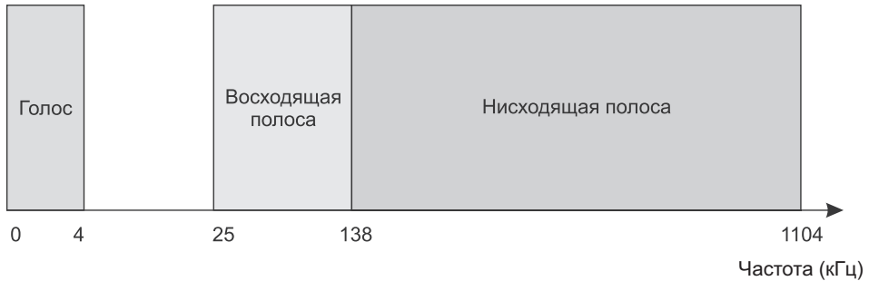
Рис. 19.9. Распределение полосы пропускания абонентского окончания между каналами ADSL
