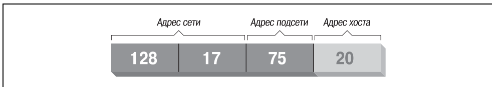
Рис. 13.2. IP-адрес с делением на подсети
