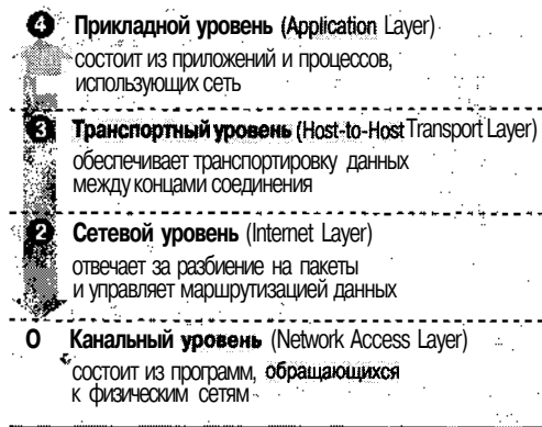
Рис. 2.1. Уровни архитектуры протокола TCP/IP
