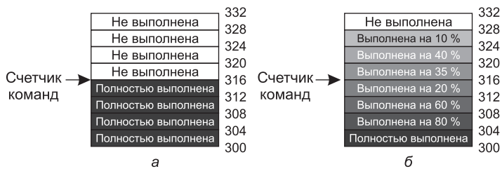
Рис. 5.5. Прерывание: а — точное; б — неточное
