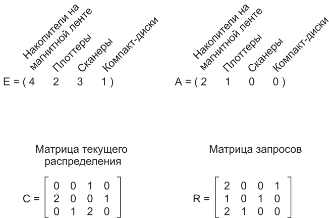
Рис. 6.5. Пример, демонстрирующий работу алгоритма обнаружения взаимоблокировок
