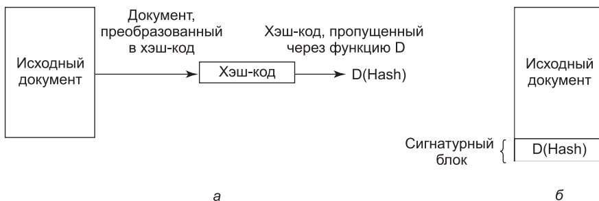
Рис. 9.14. а — вычисление сигнатурного блока; б — то, что приходит получателю
