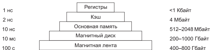
Рис. 1.9. Типичная иерархия памяти. Приведенные значения весьма приблизительны
