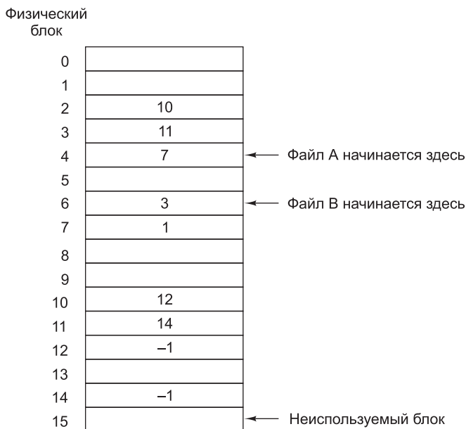
Рис. 4.9. Размещение с помощью связанного списка, использующего таблицу размещения файлов в оперативной памяти
