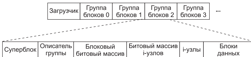
Рис. 10.17. Размещение файловой системы ext2 на диске
