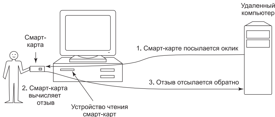
Рис. 9.17. Использование смарт-карты для аутентификации
