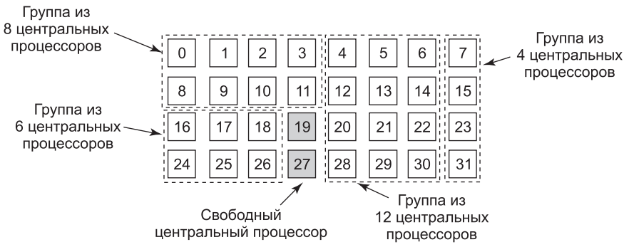
Рис. 8.13. Набор из 32 центральных процессоров, разбитый на четыре секции с двумя свободными процессорами
