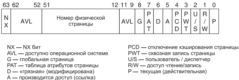
Рис. 11.17. Элемент таблицы страниц (page table entry (PTE)) отображенной страницы для архитектур Intel x86 и AMD x64
