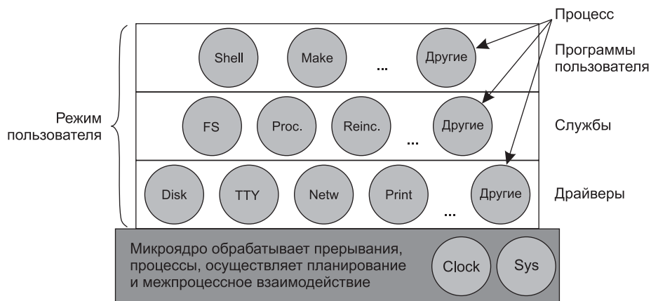
Рис. 1.22. Упрощенная структура системы MINIX 3
