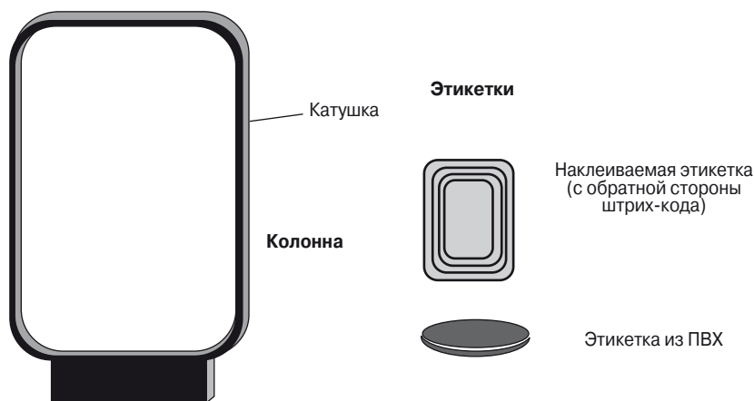
Рис. 3.4. Слева — типичная рамочная антенна для RF-систем (высота 1.20...1.60 м); справа — различные типы этикеток.
