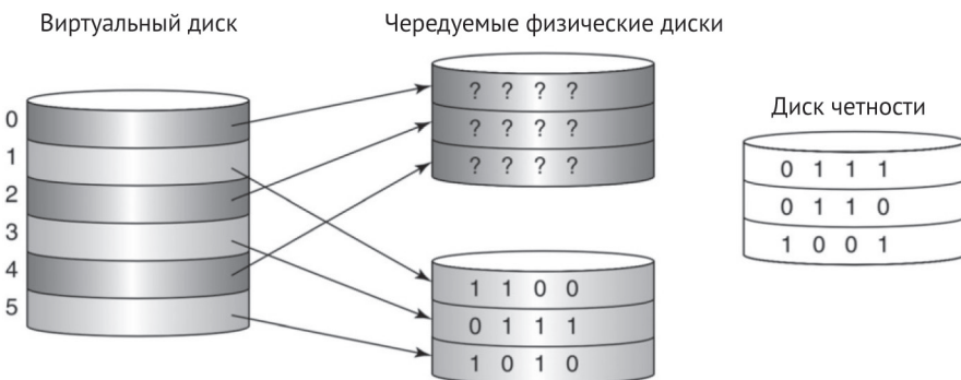
Рис. 3.8. Неисправный физический диск в массиве RAID-4
