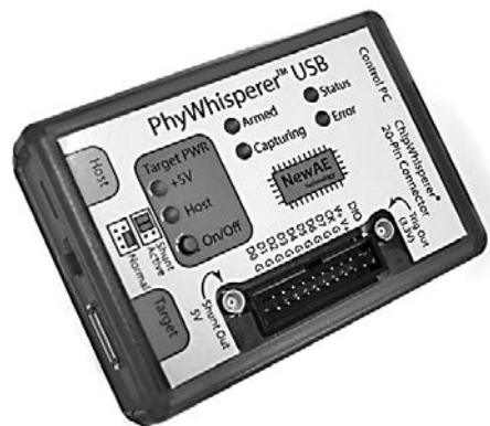
Рис. А.22. PhyWhisperer-USB — аппаратный инструмент с открытым исходным кодом для генерации триггера и анализа USB
