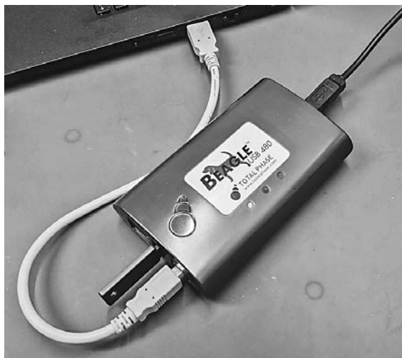
Рис. А.21. Анализаторы USB Total Phase Beagle имеют простой в использовании графический интерфейс, упрощающий декодирование протоколов
