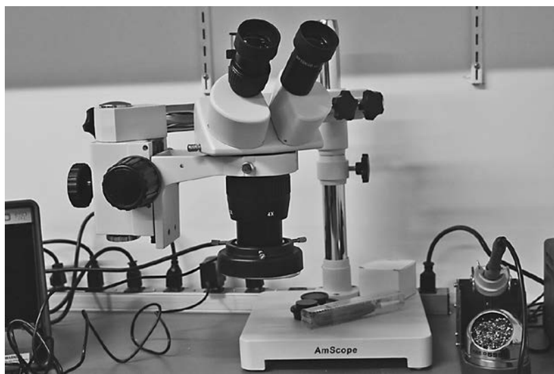
Рис. А.11. Недорогой одноштанговый оптический микроскоп AmScope с общим увеличением 10× или 20× (режимы переключаются)
