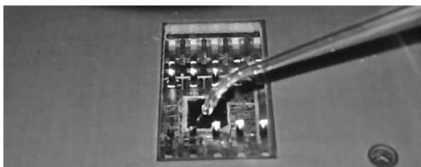
Рис. 5.28. Внедрение ошибок с помощью оптоволоконного лазера (источник: Riscure)
