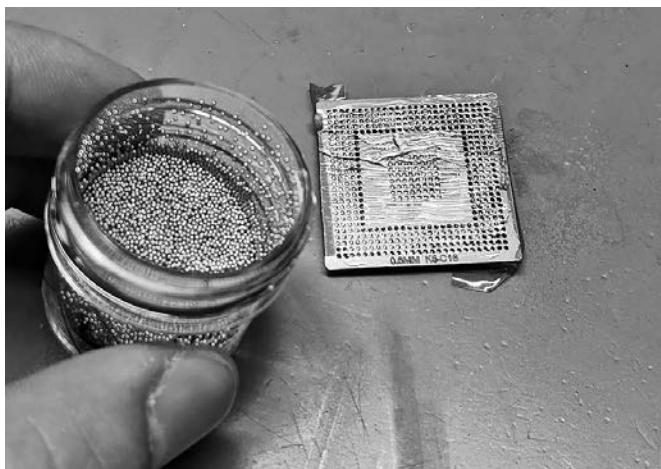
Рис. А.8. Чип с флюсом, приклеенный к трафарету. Обратите внимание, что BGA не совсем соответствует трафарету, поэтому осталось несколько темных отверстий с отсутствующими контактными площадками
