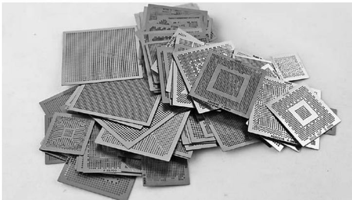
Рис. А.7. Пример недорогого набора трафаретов для восстановления шариков BGA
