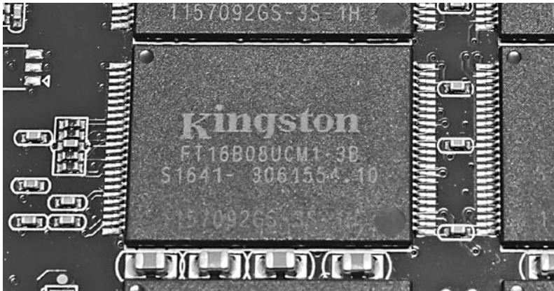
Рис. 3.14. 48-контактный корпус TSOP
