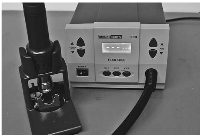
Рис. А.6. Quick 861DW — хороший термофен среднего радиуса действия
