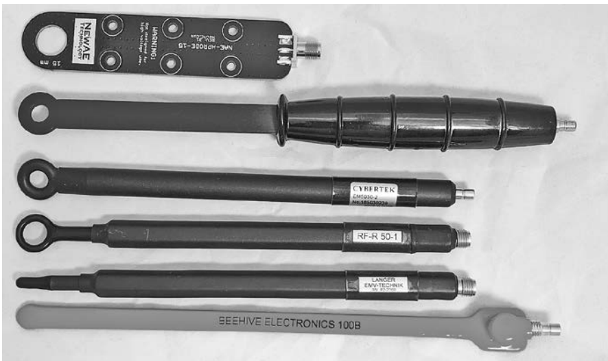
Рис. А.26. Датчики Н-поля различных производителей
