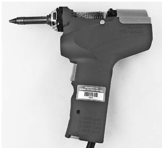
Рис. А.5. Hakko FR-301 — популярный инструмент для удаления припоя из сквозных отверстий, прямая замена показанному здесь FR-300
