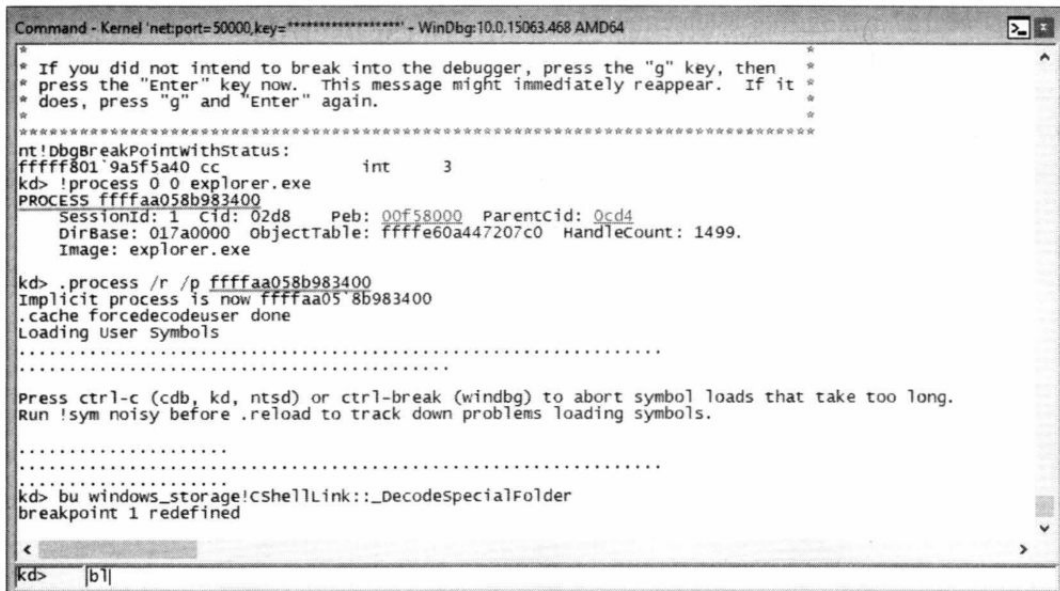
Рис. 2.22. Оттач к процессу explorer.exe и установка брейк-пойнта на _DecodeSpecialFolder
