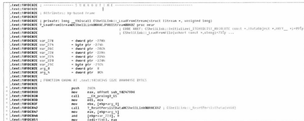
Рис. 2.4. Функция парсинга содержимого LNK-файла
