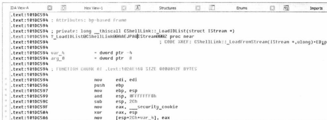
Рис. 2.8. Функция CShellLink::_LoadIDList для парсинга содержимого структуры IDList
