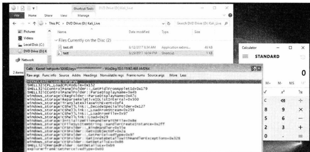
Рис. 2.26. Стек вызова функций до обработки пейлоада и результат его работы — запущенный калькулятор
