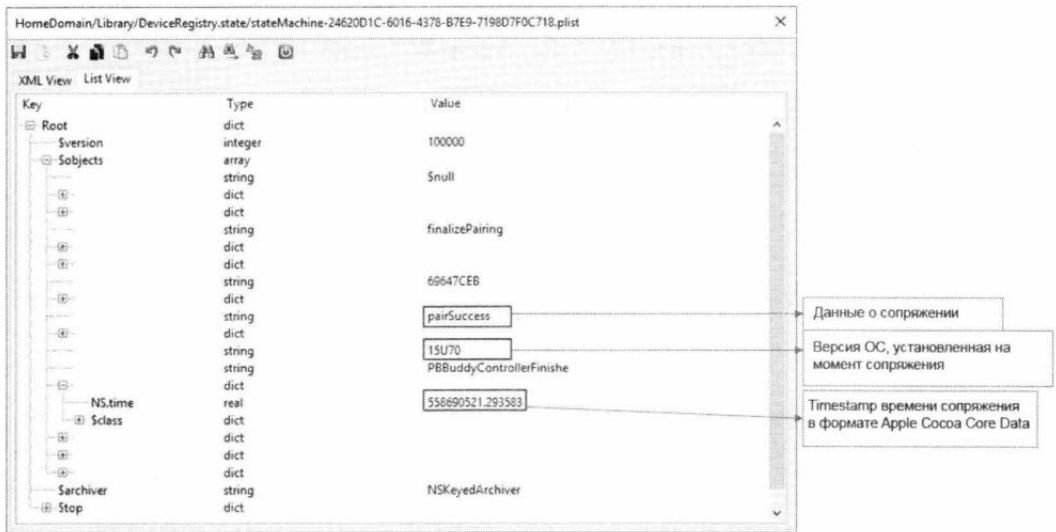
Рис. 15.3. Содержимое файла stateMachine-<GUID>.plist
