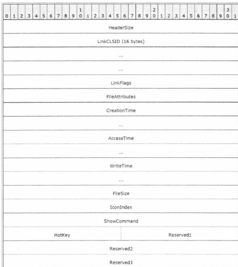
Рис. 2.5. Структура блока SHELL_LINK_HEADER
