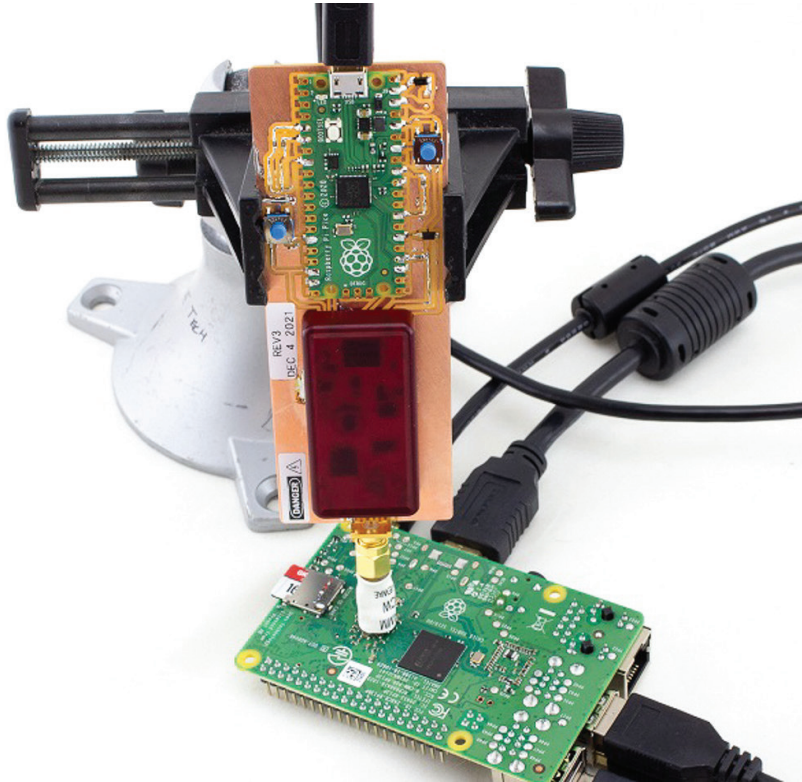
Рис. 1.52. Пример проведения EMFI-атаки 1
