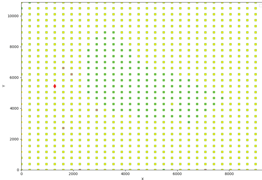
Рис. 1.55. Карта кристалла с результатами воздействия EMFI-атакой
