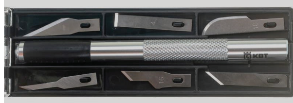
Рис. П.6. Макетный скальпель со сменными лезвиями 2
