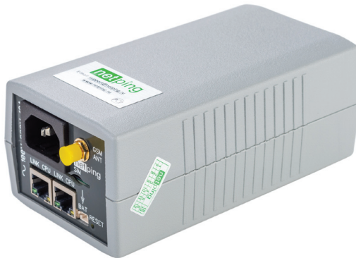
Рис. 3.6. Устройство удаленного управления питанием 220 В по сети Ethernet 2
