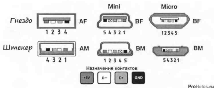
Рис. 4.8. Распиновки контактов для разных USB-портов
