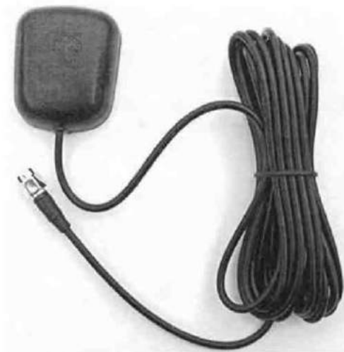
Рис. 3.26. Внешняя GPS-антенна с коннектором u.FL для усиления приема
