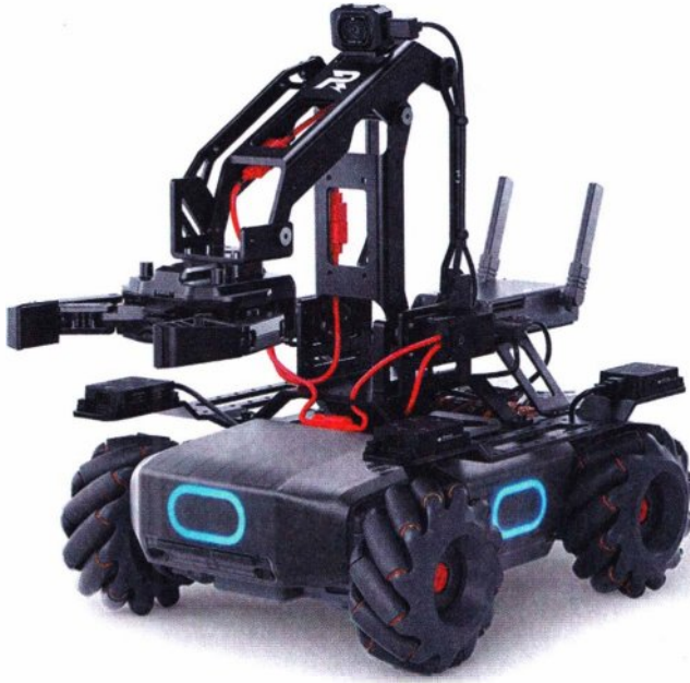
Рис. 4.9. Пример готового наземного дрона с манипулятором от компании DJI
