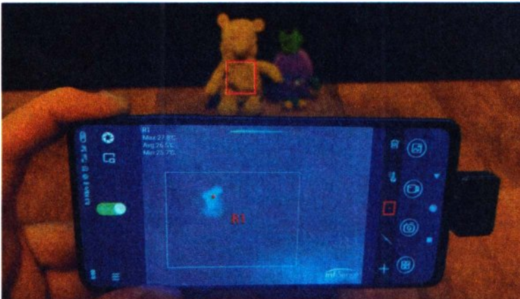
Рис. 10.9. Обнаружение теплового излучения закладки
