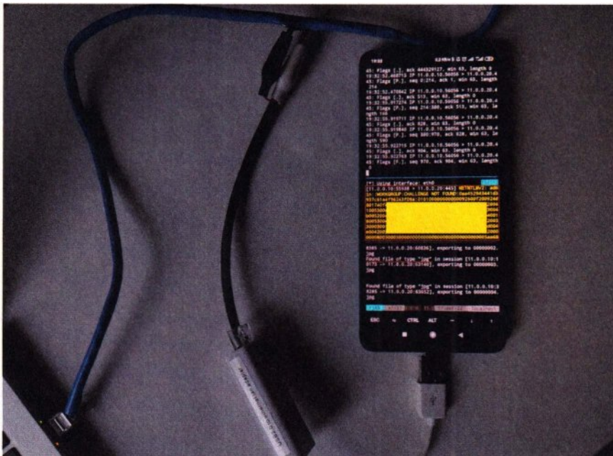
Рис. 7.56. Смартфон снимает трафик с проводов витой пары посредством «крокодилов»
