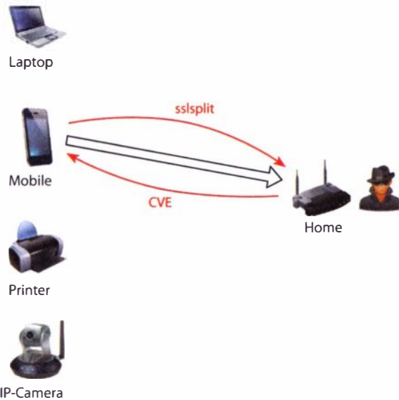
Рис. 7.33. Векторы атак на клиентское устройство — смартфон
