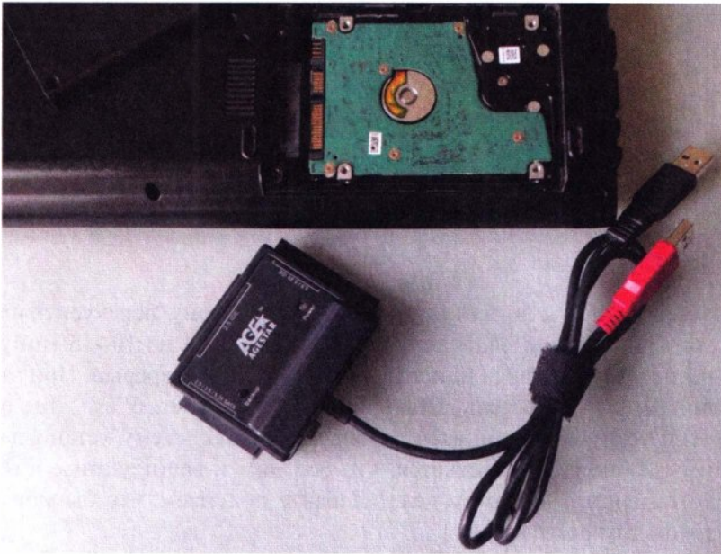
Рис. 1.1. USB-HDD адаптер для прямого доступа к диску
