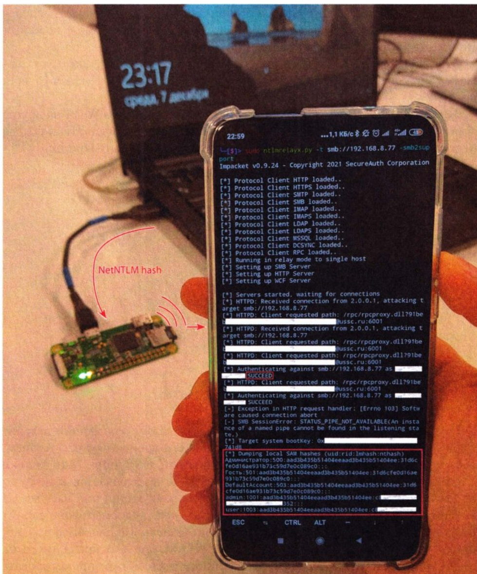
Рис. 4.7. Цепочка атак с помощью устройства BadUSB-eth
