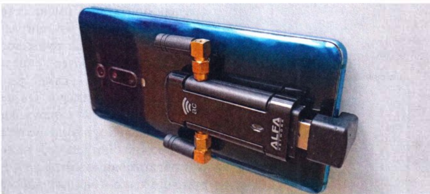
Рис. 7.10. Подключение массивных USB-устройств к смартфону с использованием 180-градусного OTG-адаптером
