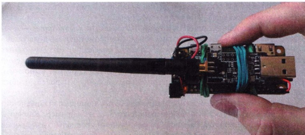
Рис. 6.14. Устройство, способное на расстоянии взломать компьютер через беспроводную периферию
