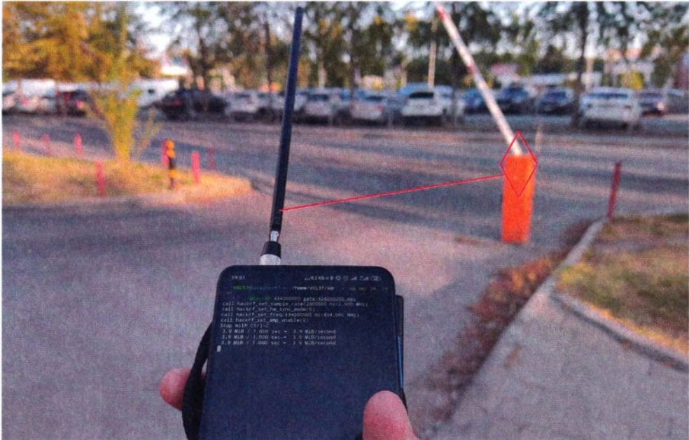
Рис. 7.48. Открывание шлагбаума передачей записанного радиосигнала
