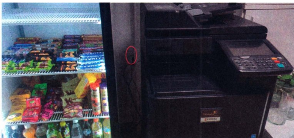
Рис. 8.1. Принтеры, IP-телефоны, серверная — везде могут быть незащищенные Ethernet-порты
