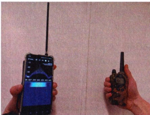
Рис. 7.50. Смартфон с помощью SDR фиксирует сигнал от рации
