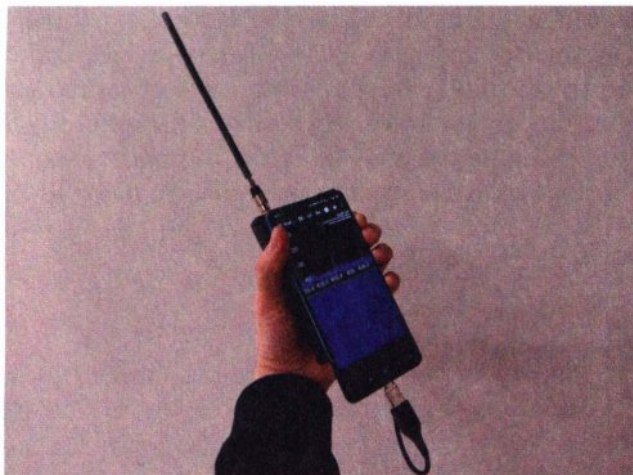
Рис. 7.46. Просмотр радиозэфира посредством SDR
