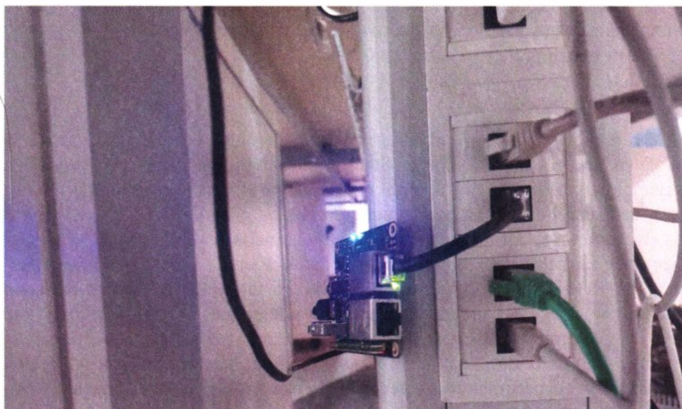
Рис. 8.9. Подключение аппаратной закладки в сетевую розетку
