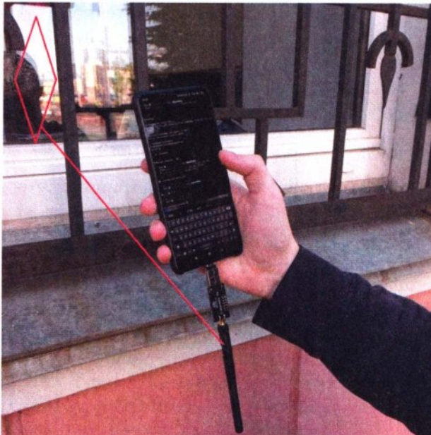
Рис. 7.45. Пробитие периметра завода: смартфон набирает на уязвимом компьютере команду для скачивания и запуска Backdoor
