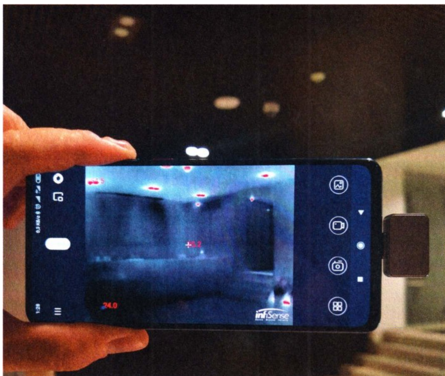
Рис. 7.67. Обнаружение техники с помощью USB-тепловизора
