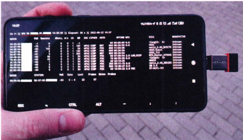
Рис. 7.13. Airodump-ng теперь фиксирует местоположение по GPS
