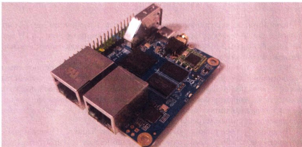
Рис. 8.3. Аппаратное решение для реализации закреплении через Ethernet
