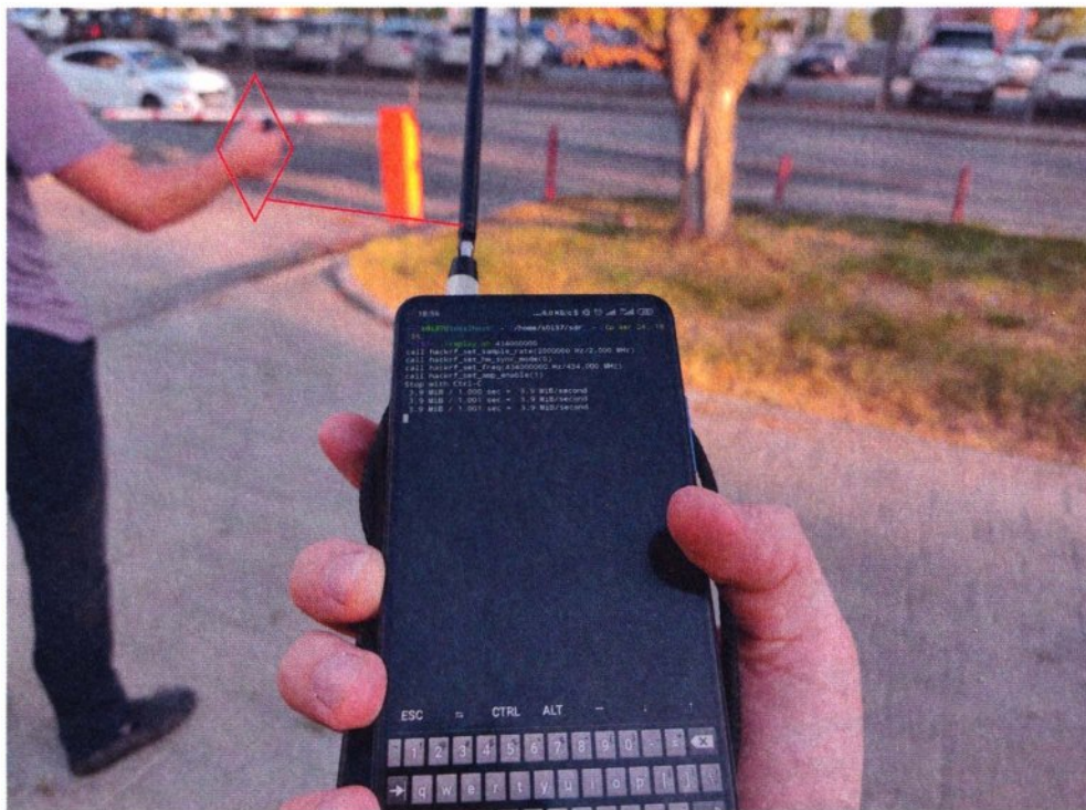
Рис. 7.47. Запись радиосигнала от беспроводного брелока для открытия шлагбаума
