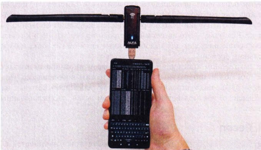
Рис. 7.9. Адаптер Wi-Fi с активным усилением управляется смартфоном
