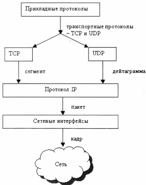
Рис. 3.4. Пересылка блока данных в стеке протоколов TCP/IP
