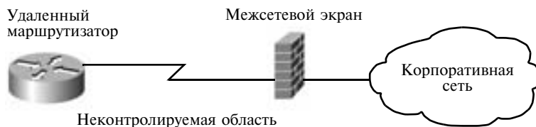
Рис. 8.3. Безопасность обмена данными между удаленным маршрутизатором и межсетевым экраном
