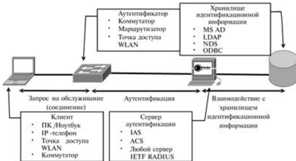
Рис. 7.9. Модель контроля доступа к портам стандарта 802.1x. Основные элементы
