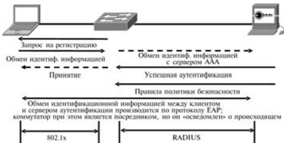
Рис. 7.10. Модель контроля доступа к портам стандарта 802.1x. Схема работы
