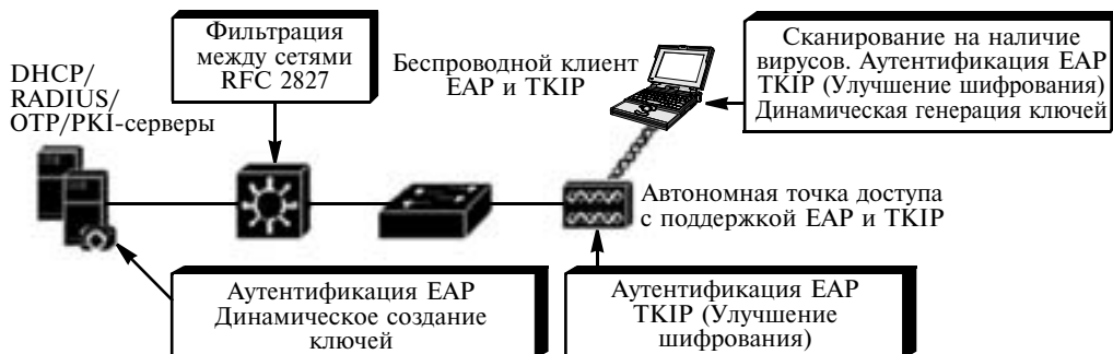
Рис. 8.12. Снижение риска атак для схемы беспроводной локальной сети с использованием WPA-802.1X EAP/TKIP
