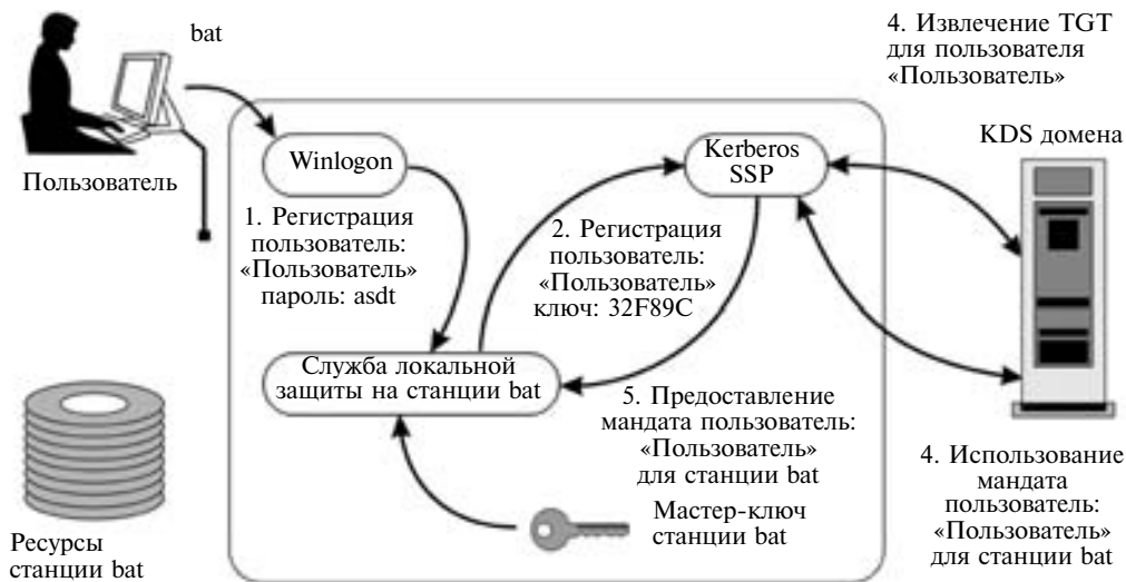
Рис. 6.5. Процесс входа в систему
