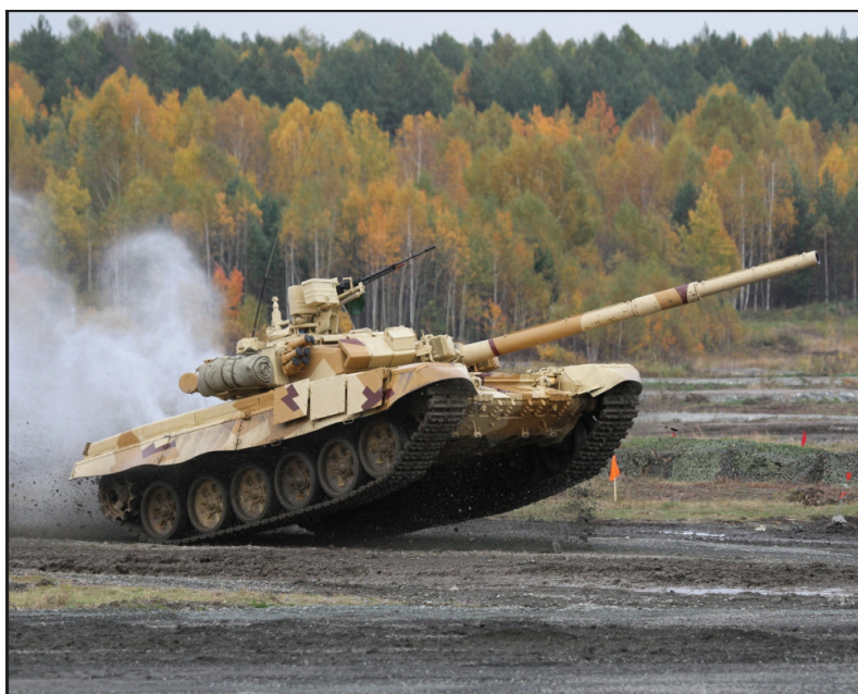
Изображение 3 ❖ Танк. Всё в нём, от цвета до угла наклона граней, подчинено требованиям функциональности. Грани танка спроектированы таким образом, чтобы площадь силуэта была минимальной, а толщина брони в каждой точке – максимальной, при минимально возможном весе
