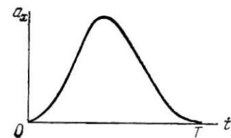
Рис. 4.2. Кривая изменения проекции кажущегося ускорения на измерительную ось акселерометра.
