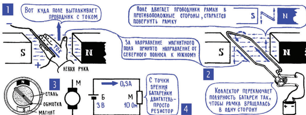
Рис. 5.6. Принцип устройства электродвигателя
