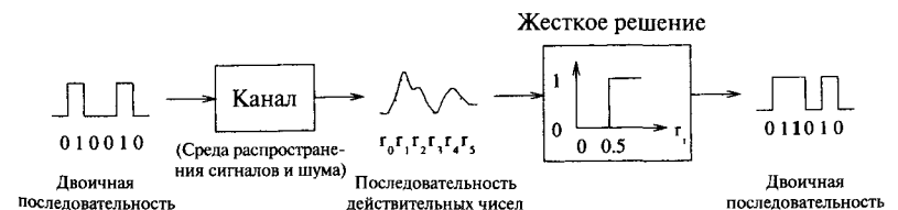
Рис. 67. Пример возникновения ошибок при декодировании с жестким решением.
