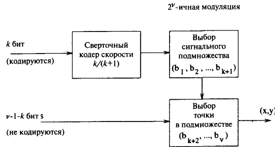
Рис. 104. Структура TCM кодера скорости (v - 1)/v .
