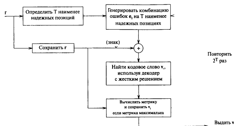
Рис. 76. Структурная схема алгоритма Чейза, Тип -II.
