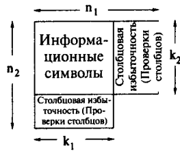
Рис. 80 Параллельный составной код, интерпретируемый как перфорированный код-произведение.
