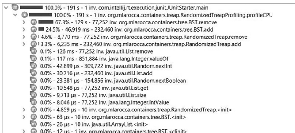
Рис. 3.21. Профилирование использования процессорного времени при вставке (удалении) случайных целых чисел из диапазона от 0 до 1000 в двоичное дерево поиска и рандомизированное декартово дерево
