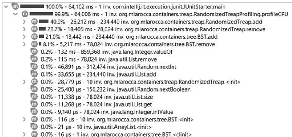
Рис. 3.20. Профилирование использования процессорного времени при вставке/удалении случайных неограниченных целых чисел из двоичного дерева поиска и рандомизированного декартова дерева
