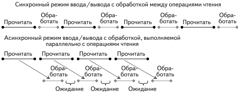
Рис. 7.1. Сравнение синхронного и асинхронного режимов ввода/вывода.
