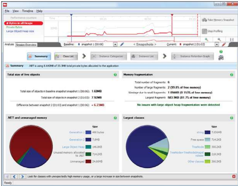
Рис. 2.27. Сравнение двух снимков динамической памяти. Общая разница между ними составляет +6.23 Мбайт, а наибольший объем занимают объекты типа System.String.
