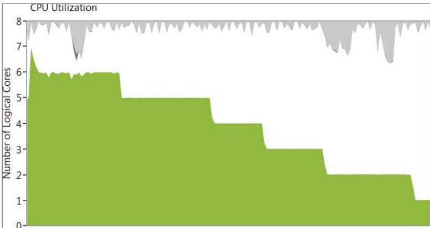
Рис. 6.2. Общее использование процессора сначала повысилось почти до 8 логических ядер (100%) а затем постепенно снижалось.
